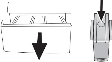
1. Если в отсеке для кондиционера начинает собираться смесь воды и кондиционирующего средства, превышающая нормальный объем, сифон следует прочистить.
