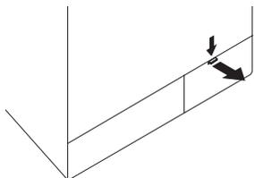
Если она состоит из двух частей, нажмите на выступ крышки фильтра вниз и извлеките ее, потянув на себя. Если она состоит из одной части,
