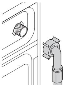
установленные на шлангах. Эти прокладки следует установить на оба конца шланга в местах подсоединения к водопроводному крану и к машине. Прямой конец шланга с фильтром следует
