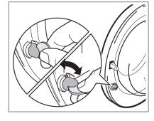
закрыть дверцу, поверните кнопку против часовой стрелки так, чтобы паз оказался в вертикальном положении.
