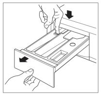
Чтобы удалить все остатки скопившегося порошка, промойте его проточной водой.
