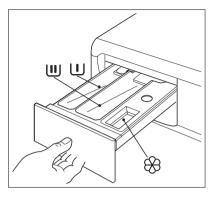
При дозировке моющих средств и добавок руководствуйтесь указаниями изготовителя и не превышайте отметку **"МАХ"** на стенке дозатора. Смягчитель тканей или крахмальные добавки необходимо заливать в отделение дозатора перед запуском программы стирки.
