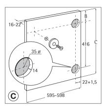
Расстояние (B) от верхней кромки дверцы до центра отверстия зависит от размеров прилегающей мебели.
