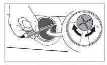
8. Установите фильтр на место, аккуратно вставив его по направляющим. Плотно закрутите крышку насоса, вращая ее по часовой стрелке.
