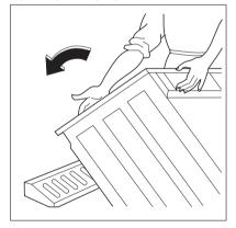
2. Отсоедините шнур питания и сливной шланг от разъемов на задней панели прибора.
