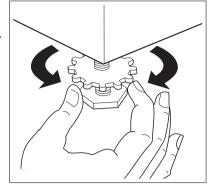
После того, как прибор будет выровнен, затяните контргайки.
